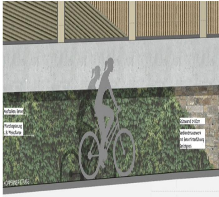
Kombination aus teilbegrünter Stützwand im Wechsel mit Natursteinverblander, oberseitigem Kopfbalken in Sichtbeton und aufgesetzter Lärmschutzwand
